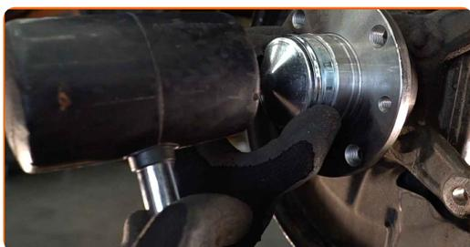
**23** Natřete náboj v místě kontaktu s brzdovým kotoučem. Použijte měděné mazivo.
