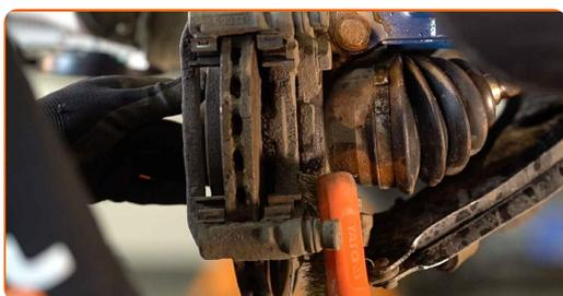
**13** Odšroubujte upevnění svorky brzdového třmenu. Použijte nástavec č.19. Použijte ráčnový klíč. Použijte vratidlo.
