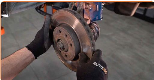
**16** Vyčistěte náboj. Použijte drátěný kartáč. Natřete kontaktní povrch. Použijte měděné mazivo.
