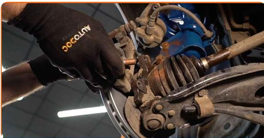
**19** Upevněte svorku brzdového třmenu. Použijte nástavec č.19. Použijte momentový klíč. Utáhněte ji točivým momentem 57 Nm.
