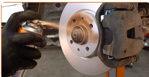
**25** Vyčistěte povrch brzdového kotouče. Použijte čistič brzd.
