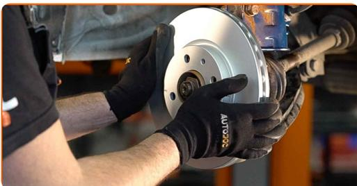
**18** Nainstalujte svorku brzdového třmenu.
