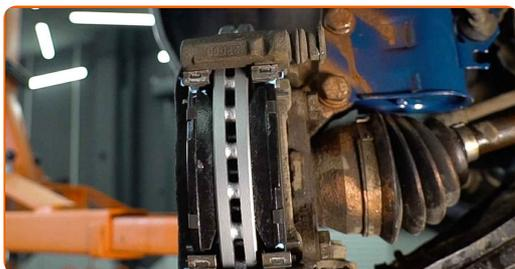
**23** Nainstalujte brzdový třmen a upevněte jej. Použijte nástavec č.13. Použijte momentový klíč. Utáhněte ji točivým momentem 27 Nm.
