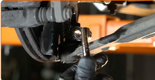
**9** Odšroubujte upevnění předního ramene. Použijte nástavec č.E18. Použijte vratidlo.
