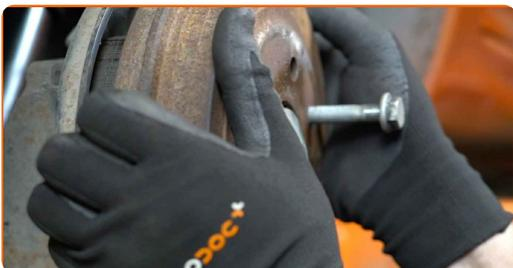
**14** Vyčistěte náboj. Použijte drátěný kartáč. Natřete kontaktní povrch. Použijte měděné mazivo.
