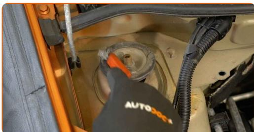
**4** Uvolněte vrchní upevňovací prvek ložiska vzpěry tlumiče. Použijte imbusový klíč č. H7. Použijte nástavec č.19. Použijte ráčnový klíč.
