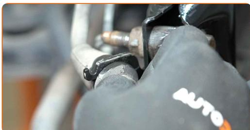
**42** Nainstalujte příčné stabilizační rameno.
