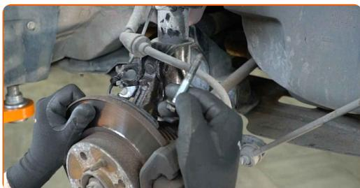
**19** Odpojte kloub řízení od vzpěry tlumiče. Použijte páčidlo.
