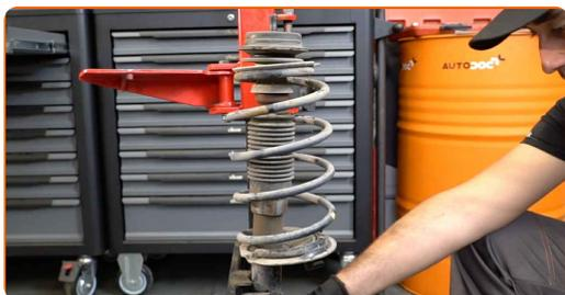
Výměna: uložení tlumiče - FIAT PUNTO Van (188AX). Tip od AUTODOC:
