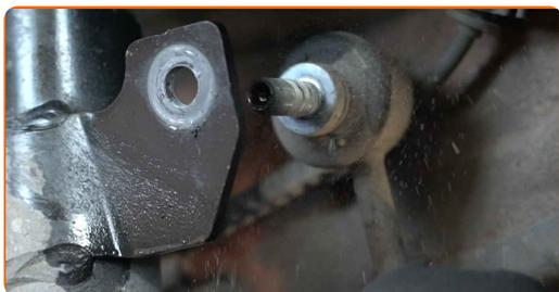
**14** Vyčistěte upevňovací prvky spojující vzpěru tlumiče a hlavu ložiska čepu kola. Použijte drátěný kartáč. Použijte sprej WD-40.
