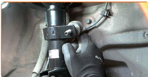
**43** Utáhněte upevnění spojující vzpěru stabilizátoru a vzpěru tlumiče. Použijte nástavec č.16. Použijte momentový klíč. Utáhněte ji točivým momentem 23 Nm.
