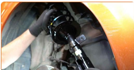
**34** Zašroubujte vrchní upevnění uložení vzpěry tlumiče. Neutahujte ho.
