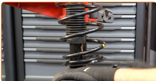
**32** Natřete montážní pozice tlumiče pérování. Použijte drátěný kartáč. Použijte sprej WD-40.
