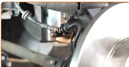
**45** Natřete povrch, kde je brzdový kotouč v kontaktu s ráfem kola. Použijte měděné mazivo.
