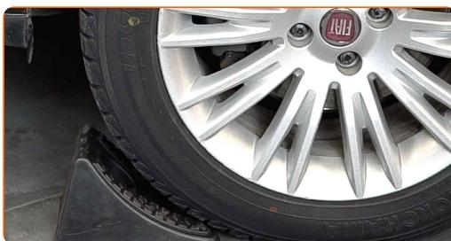
**3** Uvolněte upevňovací šrouby kola. Použijte rázový nástavec na kolo č. 17.
