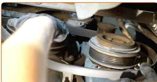
Výměna: vodní čerpadlo & sada rozvodového řemene - Ford Fiesta JA8. Tip od odborníků z AUTODOC:
