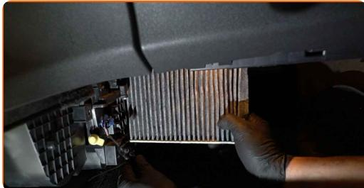
Výměna: kabinového filtru - FORD Fiesta Mk7 Van. Doporučují odborníci z AUTODOC:
