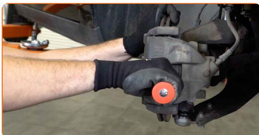
8 Vyčistěte upevňovací prvky držáku brzdového třmenu. Použijte drátěný kartáč. Natřete upevňovací prvky držáku brzdového třmenu. Použijte sprej WD-40.
