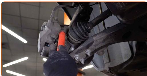
9 Odšroubujte upevnění svorky brzdového třmenu. Použijte nástavec č.14. Použijte vratidlo. Použijte ráčnový klíč.
