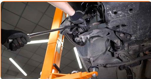
10 Odstraňte brzdový třmen spolu s jeho držákem.
