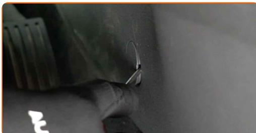
2 Odšroubujte upevňovací prvky bočního plastového ozdobného panelu. Použijte hvězdicový Torx T 20.
