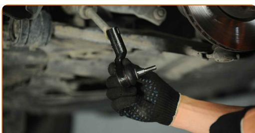
Výměna: kulového čepu řízení - FORD FOCUS III limuzína. Tip od odborníků z AUTODOC:
