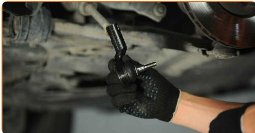
Výměna: kulového čepu řízení - FORD FOCUS III Turnier. Tip od odborníků z AUTODOC:
