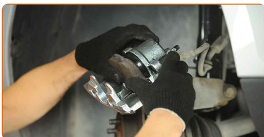
Výměna: brzdového třmenu - FORD FOCUS III. Doporučují odborníci z AUTODOC:
