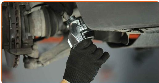
**26** Očistěte vodící závlačky brzdového třmenu.
