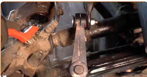
Výměna: brzdového třmenu - FORD FOCUS III. AUTODOC doporučuje:
