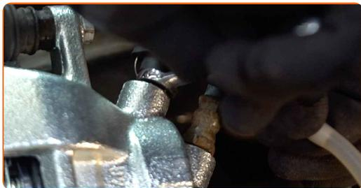
**35** Vypusťte systém brzdového třmenu. Bez nastartování motoru stlačte brzdový pedál několikrát, dokud nebudete cítit značný odpor.
