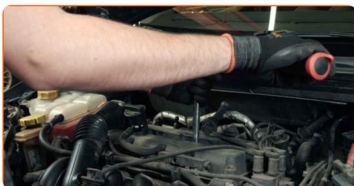
Výměna: zapalovacích svíček - FORD FOCUS III. AUTODOC doporučuje:
