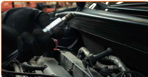
**14** Aplikujte tenkou vrstvu speciálního vysokoteplotního maziva proti zadření na závity nových svíček zapalování.
