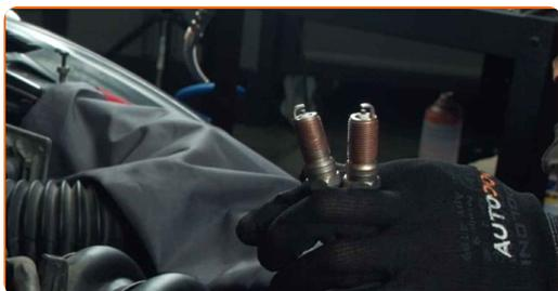
**15** Nainstalujte nové svíčky zapalování do otvorů pro jejich montáž.
