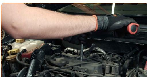
Výměna: zapalovacích svíček - FORD FOCUS kombík (DNW). AUTODOC doporučuje:
