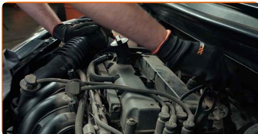
Výměna: zapalovacích svíček - FORD FOCUS kombík (DNW). Profesionálové doporučují:
