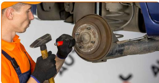
Výměna: ložiska kola - FORD FOCUS kombík (DNW). AUTODOC doporučuje:
