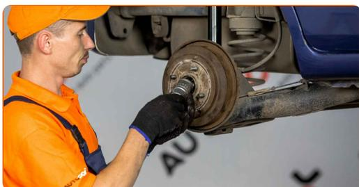
Výměna: ložiska kola - FORD FOCUS kombík (DNW). Doporučují odborníci z AUTODOC:
