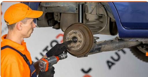
**9** Odšroubujte upevnění ložiska náboje. Použijte nástavec č.30.
