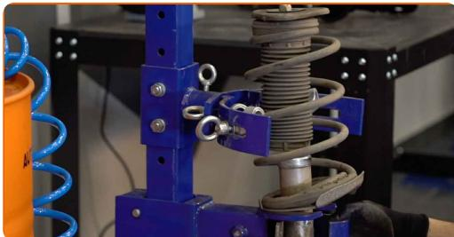
Výměna: pérovací jednotka - FORD Focus Mk2 Cabrio (DB3). Tip od odborníků
