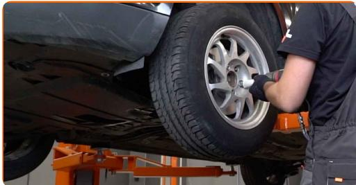
Výměna: přední spodní rameno - FORD Focus Mk2 Cabrio (DB3). Tip:
