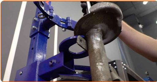
Výměna: pérovací jednotka - FORD Focus Mk2 Combi (DA\_, FFS, DS).
