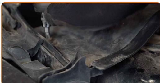
10 Odstraňte upevnění spodního plastového krytu pod stěrače.
