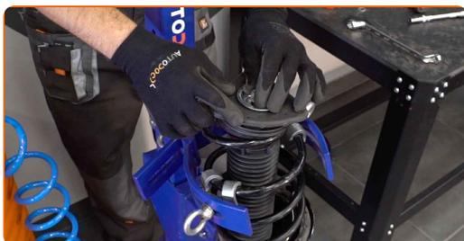
39 Upevněte matici pístu vzpěry tlumiče. Použijte imbusový klíč č. H6. Použijte kombinační klíč č.19. Použijte momentový klíč. Utáhněte ji točivým momentem 50 Nm.
