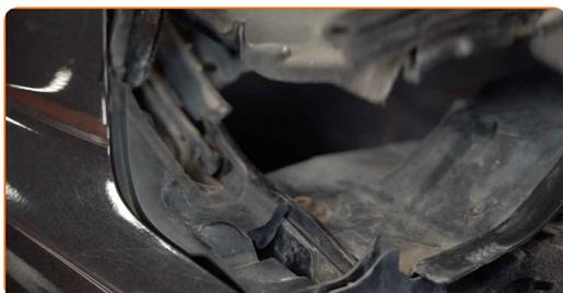
9 Odšroubujte upevňovací prvek spodního plastového krytu pod stěrače. Použijte hvězdicový Torx T 30. Použijte ráčnový klíč.
