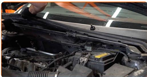
11 Uvolněte vrchní upevňovací prvek ložiska vzpěry tlumiče. Použijte nástavec č.13. Použijte ráčnový klíč.
