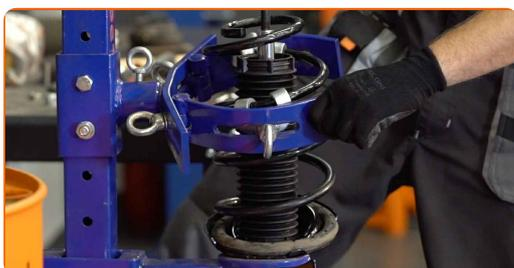
38 Nainstalujte vrchní držák pružinové vzpěry a ložisko vzpěry.
