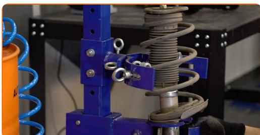
Výměna: pérovací jednotka - FORD Focus Mk2 Combi (DA\_, FFS, DS). Tip od odborníků z AUTODOC:
