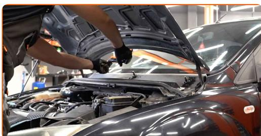
7 Odstraňte držáky plastové mřížky pro odvádění vody. Použijte páčidlo.
