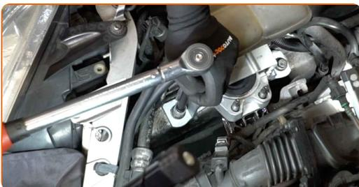
**16** Natřete upevňovací prvky uložení motoru. Použijte měděné mazivo.
