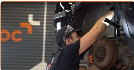
**21** Nainstalujte ložisko tlumiče za použití středového otvoru jako vodícího prvku.
