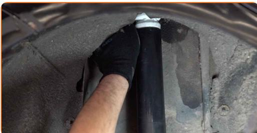
Výměna: tlumiče pérování - FORD Focus Mk2 Kasten / Combi. AUTODOC doporučuje:
