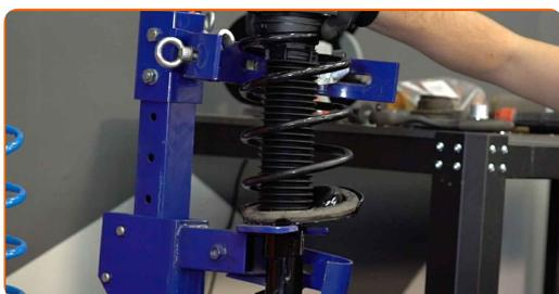
38 Vyčistěte montážní pozice vzpěry tlumiče. Použijte drátěný kartáč. Použijte sprej WD-40.
