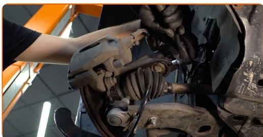
23 Odpojte kloub řízení od vzpěry tlumiče. Použijte páčidlo.
