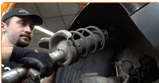
27 Nastavte vzpěru tlumiče na zařízení pro stlačení pružiny.
