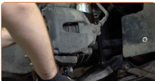
24 Odšroubujte vrchní upevnění vzpěry tlumiče.
