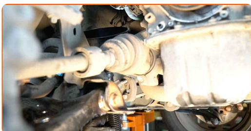
**43** Vyčistěte výpustný uzávěr chladicí kapaliny. Použijte víceúčelový čisticí sprej.
