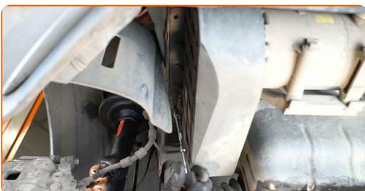
**10** Odstraňte spodní kryt drážkovaného klinového řemene.
