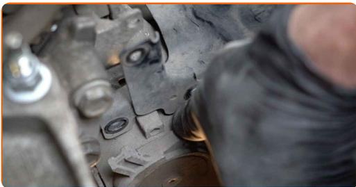
**110** Zašroubujte upevňovací prvky držáku svazku vodičů motoru. Zašroubujte upevňovací prvky držáku svazku vodičů alternátoru. Použijte nástavec č.10. Použijte ráčnový klíč.
