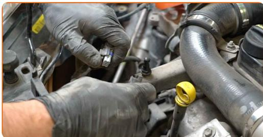
**21** Odšroubujte upevňovací prvky držáku svazku vodičů motoru. Použijte nástavec č.10. Použijte ráčnový klíč.
