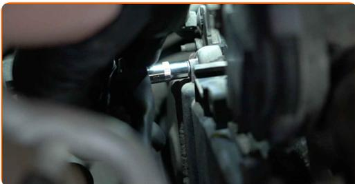
**8** Odstraňte vrchní kryty rozvodů motoru.
