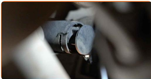
**44** Odstraňte zádržnou sponu výpustného uzávěru chladicí kapaliny.
