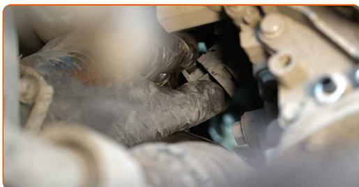
**45** Odstraňte výpustný uzávěr chladicí kapaliny.
