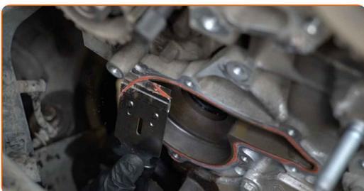
**74** Nainstalujte těsnění vodní pumpy.
