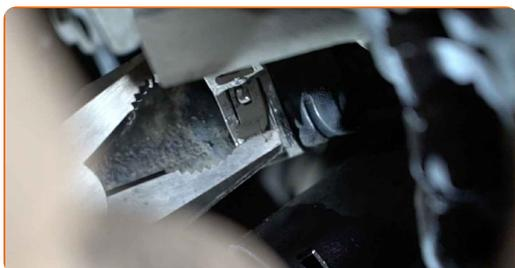
**121** Nainstalujte výpustný uzávěr chladicí kapaliny.
