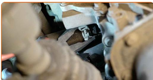
**50** Odpojte spodní trubku na chladicí kapalinu.
