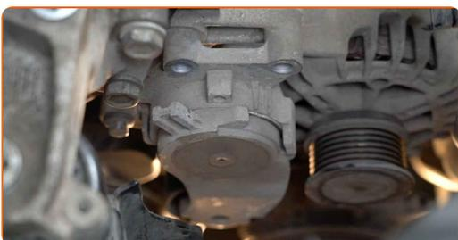
**109** Nainstalujte držák svazku vodičů alternátoru.
