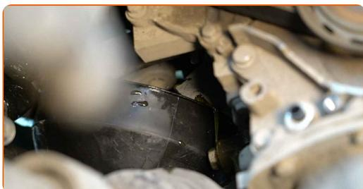
**46** Vypusťte chladicí kapalinu z motoru.
