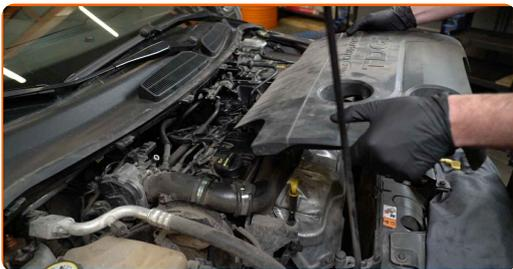
Výměna: vodní čerpadlo & sada rozvodového řemene - FORD Focus Mk3 Sedan (DYB). Profesionálové doporučují:
