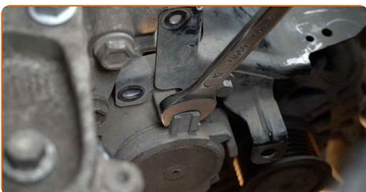
**112** Zašroubujte upevňovací prvky napínací kladky drážkovaného klinového řemene. Použijte nástavec č.10. Použijte ráčnový klíč.
