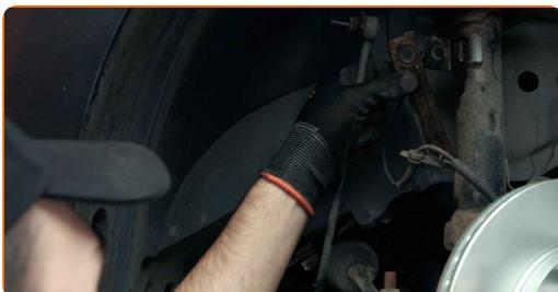
Výměna: tyčky stabilizátoru - FORD FUSION limuzína CD3 Doporučují odborníci z AUTODOC:
