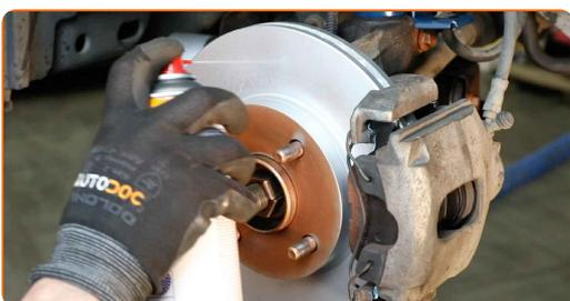
**Výměna: brzdového třmenu - FORD Kuga Mk2 (DM2). Tip:**
