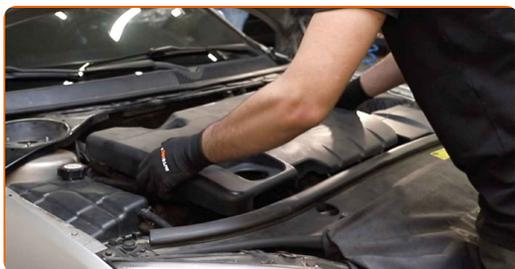
**Výměna: zapalovací cívky - FORD MONDEO III (B5Y). Tip od AUTODOC:**
