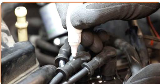
6 Odpojte vodiče svíček zapalování z cívky zapalování.
