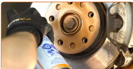
**46** Vyčistěte povrch brzdového kotouče. Použijte čistič brzd.
