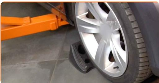
**2** Uvolněte upevňovací šrouby kola. Použijte rázový nástavec na kolo č. 19.
