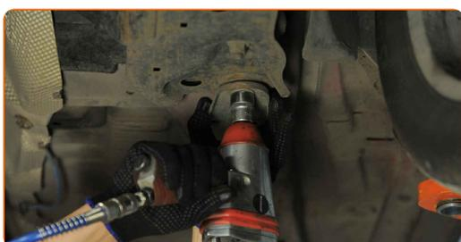
**18** Podepřete rameno. Použijte zvedák s hydraulickými převody.
