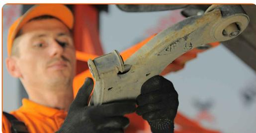
**23** Vyčistěte montážní otvory a závit ramene odpružení. Použijte drátěný kartáč. Použijte sprej WD-40.
