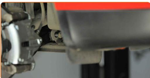
**38** Zašroubujte upevnění předního ramene. Použijte nástavec č.15. Použijte ráčnový klíč.
