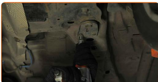
**13** Odstraňte přední upevňovací prvek ovládacího ramene. Použijte páčidlo.
