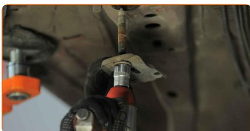
**17** Odšroubujte upevňovací prvek svorky, která spojuje rameno zavěšení kol ke karoserii auta. Použijte nástavec č.21. Použijte ráčnový klíč.
