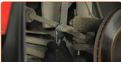
**11** Odpojte koncovku táhla od kloubu řízení. Použijte stahovák na kulové čepy.
