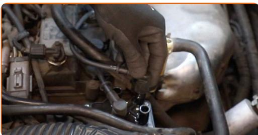
Výměna: zapalovacích kabelů - FORD MONDEO III kombík (BWY). Tip od odborníků z AUTODOC:
