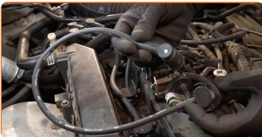
Výměna: zapalovacích kabelů - FORD MONDEO III kombík (BWY). Tip:
