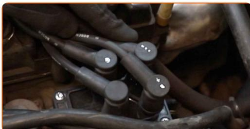
**5** Odpojte vodiče svíček zapalování z cívky zapalování. Odpojte vodiče zapalovací svíčky od zapalovacích svíček.
