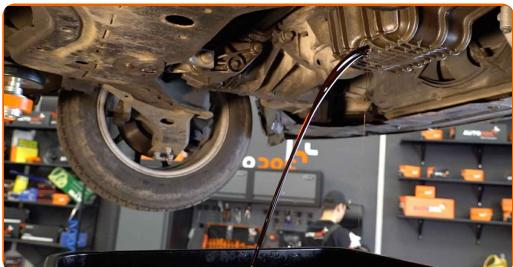
**Výměna: motorového oleje a filtru - FORD Mondeo Mk4 Hatchback (BA7). Tip:**
