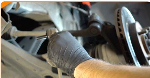
Výměna: tyčky stabilizátoru - FORD TOURNEO COURIER Kombi. AUTODOC doporučuje:
