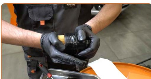
Výměna: motorového oleje a filtru - FORD Tourneo Courier. Doporučují odborníci z AUTODOC:
