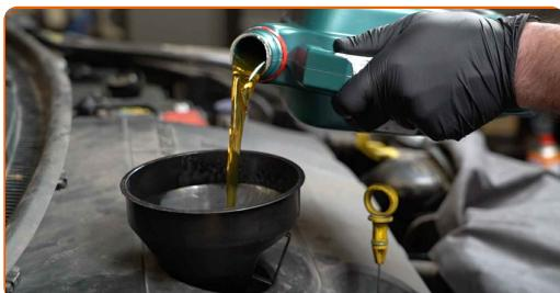
Výměna: motorového oleje a filtru - FORD Tourneo Courier. AUTODOC doporučuje:
