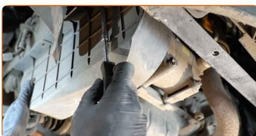
**16** Utáhněte upevnění spodního krytu olejové vany. Použijte hvězdicový Torx T30. Použijte ráčnový klíč.
