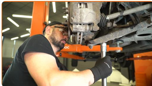
Výměna: kulový čep ramene - FORD Transit Mk5 Valník/Podvozek (V184, V185). Doporučují odborníci z AUTODOC:
