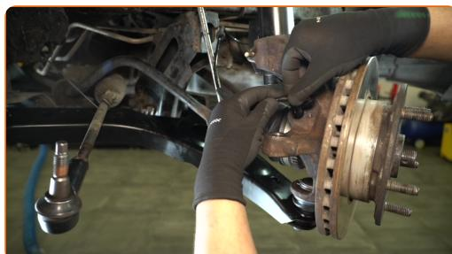
Výměna: kulový čep ramene - FORD Transit Mk5 Valník/Podvozek (V184, V185). Tip od odborníků z AUTODOC:
