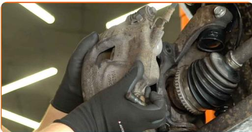
Výměna: ložiska kola - FORD Transit Mk6 Mikrobus (V347, V348). AUTODOC doporučuje:
