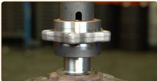
Výměna: ložiska kola - FORD Transit Mk6 Mikrobus (V347, V348). Tip od odborníků z AUTODOC:
