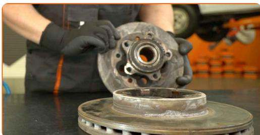
**31** Vyčistěte povrch brzdového kotouče, který je v kontaktu s ráfkem kola. Použijte drátěný kartáč.
