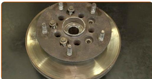
**39** Našroubujte upevňovací prvky brzdového kotouče. Použijte nástavec o průměru 13 mm. Použijte ráčnový klíč.
