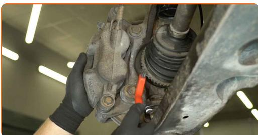
**18** Odšroubujte upevňovací prvky držáku brzdového třmene. Použijte nástavec o průměru 18 mm. Použijte otočný kolík.
