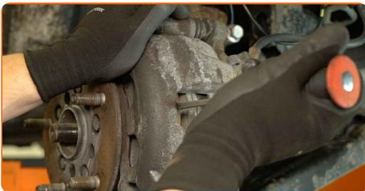
**17** Vyčistěte upevňovací prvky držáku brzdového třmene. Použijte drátěný kartáč. Použijte sprej WD-40.
