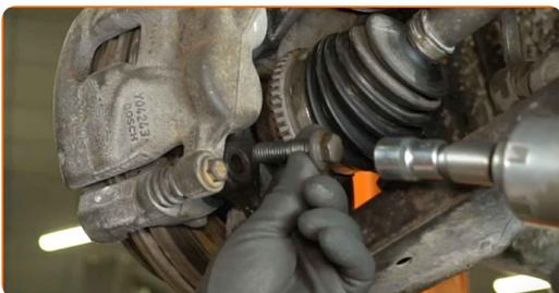
**20** Odstraňte brzdový třmen spolu s jeho držákem.
