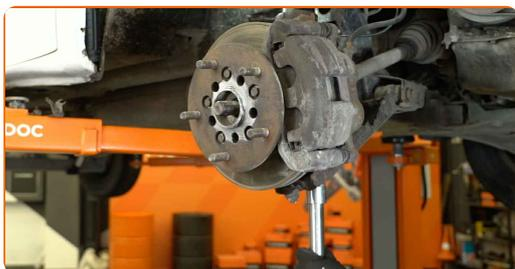
**14** Odpojte hnací hřídel od hlavy ložiska čepu. Použijte průbojník. Použijte kladivo.
