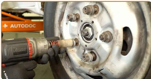
**56** Spusťte vůz a utáhněte matice kol v křížovém pořadí. Použijte úderovou rázovou hlavici na matice kol o průměru 21 mm. Použijte momentový klíč. Utahovací moment: 200 N·m.
