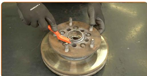
**28** Odšroubujte upevňovací prvky brzdového kotouče. Použijte nástavec o průměru 13 mm. Použijte ráčnový klíč.
