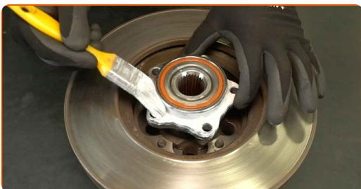
**41** Namontujte náboj kola spolu s brzdovým kotoučem.
