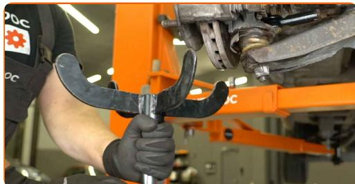
Výměna: pružiny podvozku - FORD Transit Mk6 Tourneo. AUTODOC doporučuje:
