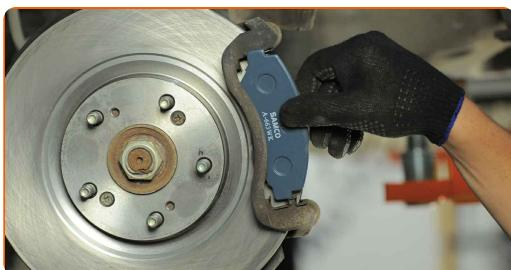
Výměna: brzdové destičky - HONDA Accord VII Tourer (CM, CN). Tip:
