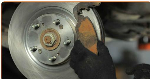
Výměna: brzdové destičky - HONDA Accord VII Tourer (CM, CN). Tip od AUTODOC:
