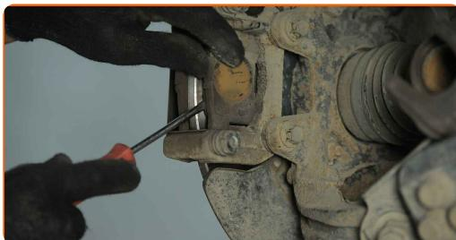
Výměna: brzdové destičky - HONDA Accord VII Tourer (CM, CN). AUTODOC doporučuje:
