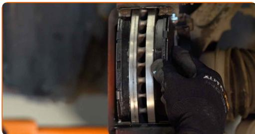
Výměna: brzdové destičky - HONDA ACCORD VIII kombík. Tip od AUTODOC:
