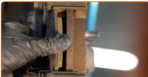
Výměna: brzdové destičky - HONDA CIVIC IX limuzína (FB, FG). Doporučují odborníci z AUTODOC:
