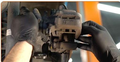
Výměna: brzdové destičky - HONDA CIVIC IX limuzína (FB, FG). Profesionálové doporučují:
