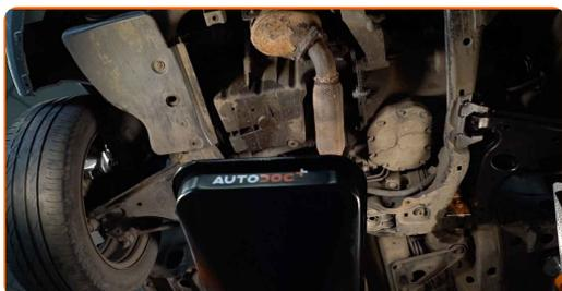
3 Vyčistěte místo výpustného otvoru olejové vany. Použijte drátěný kartáč. Použijte víceúčelový čisticí sprej.
