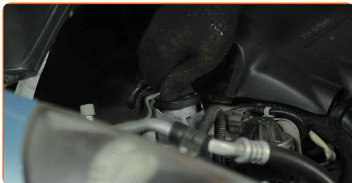
22 Motor nechte několik minut běžet. Po tom, co varovné světlo tlaku oleje zmizí, vypněte motor.
