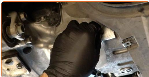
7 Zašroubujte novou zátku výpustného otvoru a utáhněte ji. Použijte nástavec č.17. Použijte momentový klíč. Utáhněte ji točivým momentem 39 Nm.
