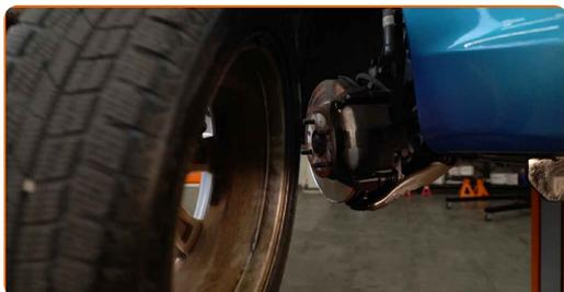
**7** Vyčistěte upevňovací prvky brzdového třmenu. Použijte drátěný kartáč. Použijte sprej WD-40.
