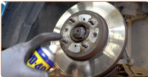
**16** Odšroubujte upevnění brzdového kotouče. Použijte křížový šroubovák PH. Použijte nárazový šroubovák.
