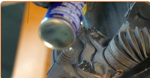
**13** Odšroubujte upevnění svorky brzdového třmenu. Použijte nástavec č.19. Použijte vratidlo. Použijte ráčnový klíč.
