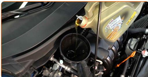
Výměna: motorového oleje a filtru - HONDA Pilot III. Doporučují odborníci z AUTODOC:
