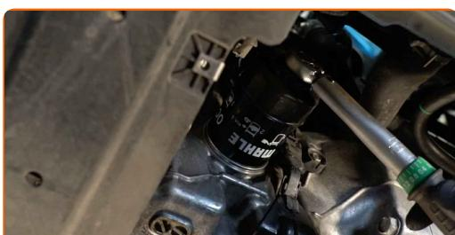
Výměna: motorového oleje a filtru - HONDA Pilot III. Tip od odborníků z AUTODOC:
