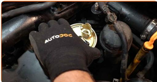
Výměna: palivového filtru - HYUNDAI ELANTRA limuzína (HD). Tip od AUTODOC:
