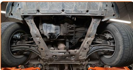
**9** Pod výpustný otvor položte nádobu na vytékající olej o objemu alespoň 5 l.
