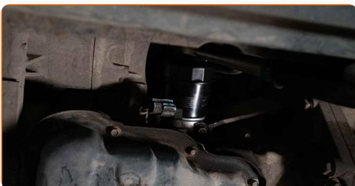
**14** Odstraňte olejový filtr. Připravte nádobu pro starý olejový filtr. Starý olejový filtr vložte do nádoby.
