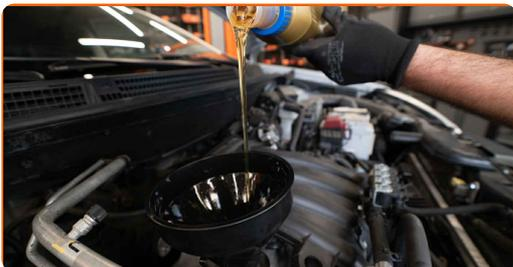
Výměna: motorového oleje a filtru - INFINITI M37 IV Sedan (Y51). Tip:
