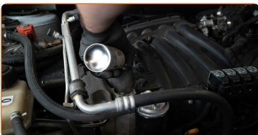
**4** Nainstalujte uzávěr olejového systému.
