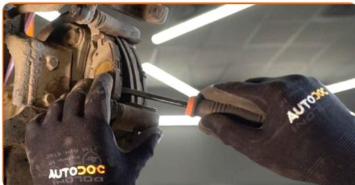
Výměna: brzdové destičky - INFINITI Q70 (Y51). Doporučují odborníci z AUTODOC:
