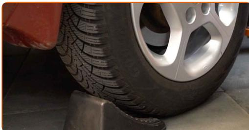
**3** Uvolněte upevňovací šrouby kola. Použijte rázový nástavec na kolo č. 21.
