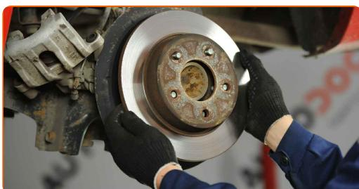
**19** Vyčistěte náboj. Použijte drátěný kartáč. Natřete kontaktní povrch. Použijte měděné mazivo.
