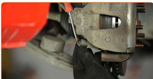
**9** Vyčistěte upevňovací prvky brzdového třmenu. Použijte drátěný kartáč. Použijte sprej WD-40.
