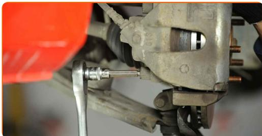
**11** Odstraňte vodící závlačky z brzdového třmenu.
