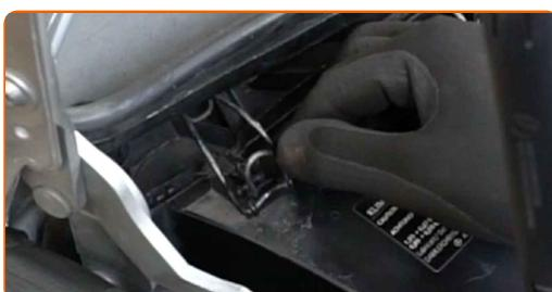
**4** Odstraňte kryt uložení kabinového filtru.
