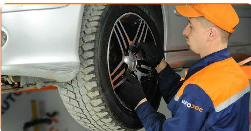
**6** Vyčistěte upevňovací šroub, který spojuje vidlici tlumiče odpružení se spodním ovládacím ramenem. Použijte drátěný kartáč. Použijte sprej WD-40.
