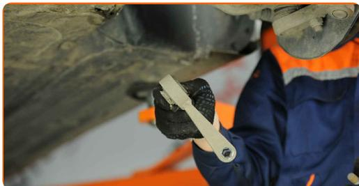
**16** Vyčistěte montážní pozice vzpěry stabilizátoru. Použijte drátěný kartáč. Použijte sprej WD-40.
